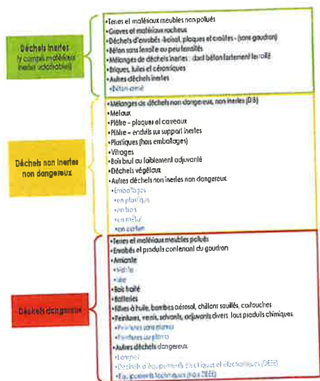
Figure 2 : Classification des déchets de BTP (source : CD74)
