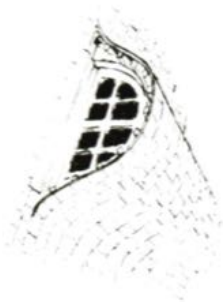
Lucarne à joues galbées (couverture ardoise ou chaume)
